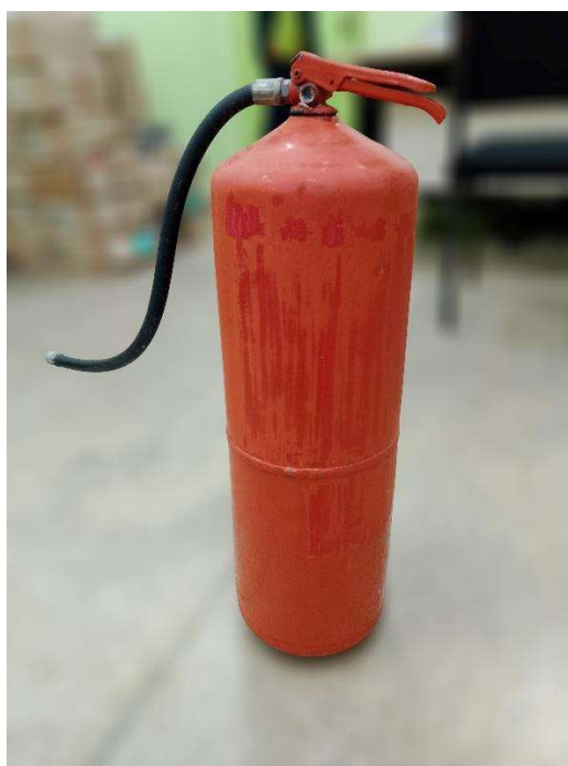
Figura 12 - Extintor danificado (1)
